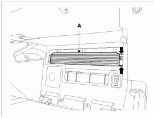
3. 更换空气滤清器(B),确认空气滤清器的方向后进行安装。
